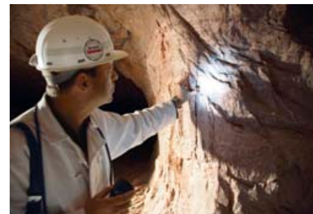
Ein Steiger prüft das Gestein auf seine Zusammensetzung, um den weiteren Abbau zu planen. Mit Hilfe moderner Diagnoseinstrumente stellt der Fachmann dann die genaue Lage der Wertstoffkomponenten fest, bevor die Sprengung vorbereitet werden kann.
